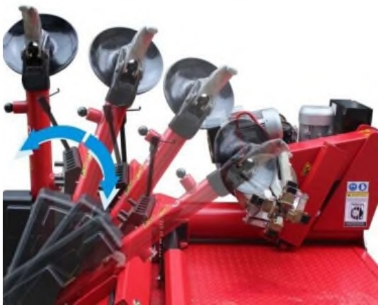
Posicionamiento automático del brazo de trabajo
